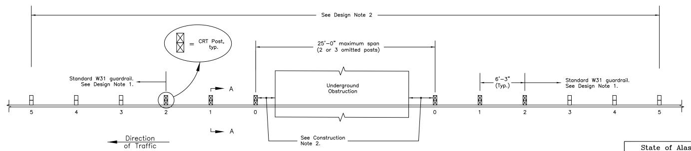
LONG SPAN GUARDRAIL PLAN
